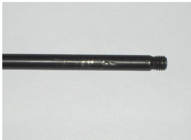
Slika 32: Primjer mehaničkog oštećenja klipnjače
