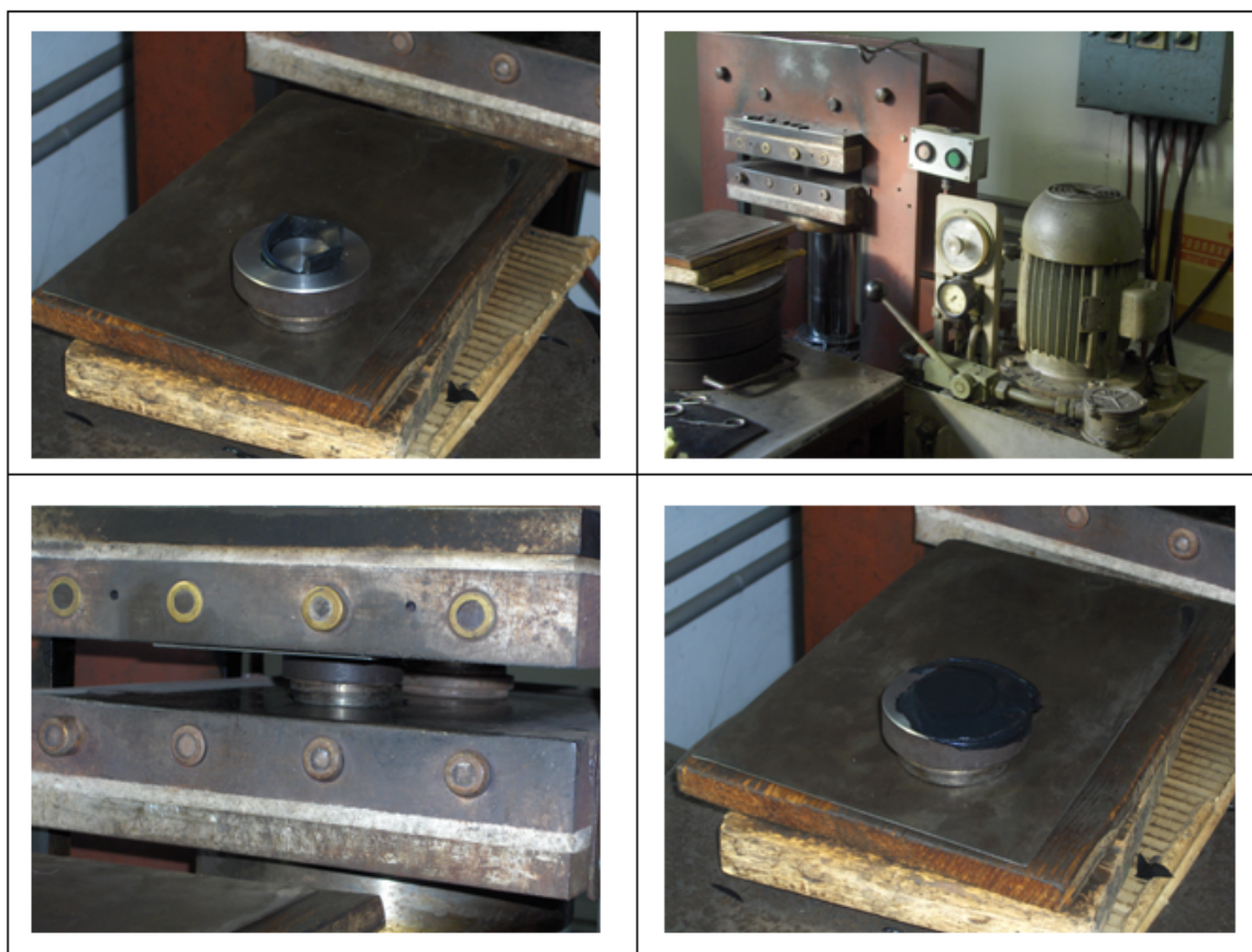
Slika 81: Detalji izrade gumenog prstena
