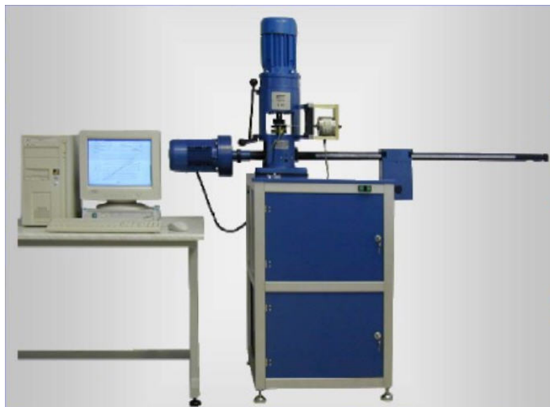
Slika 19: Prikaz uređaja za ispitivanje metodom 4 kuglice, [8]
