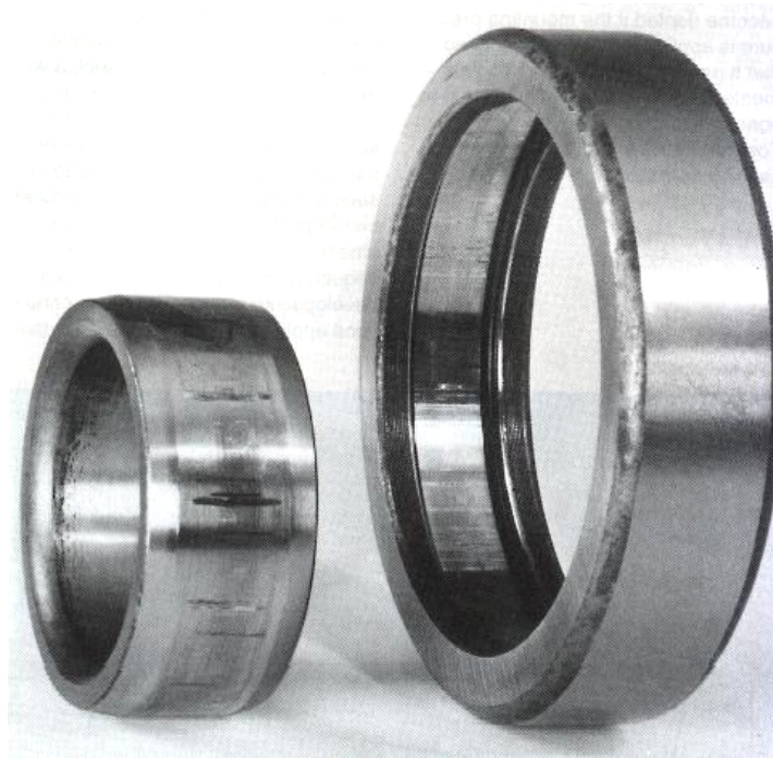
Slika 2: Istrošenost unutarnjeg i vanjskog prstena valjanog ležaja, [4]
