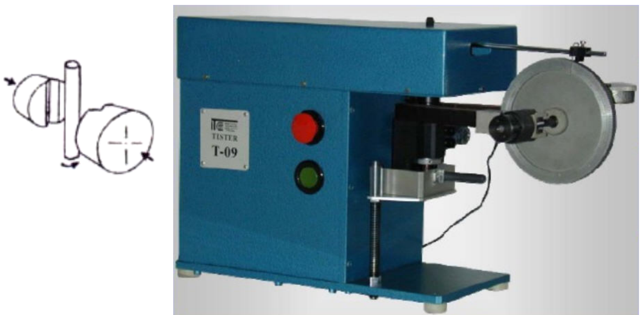
Slika 24: Prikaz uređaja za ispitivanje bloc on pin, [8]
