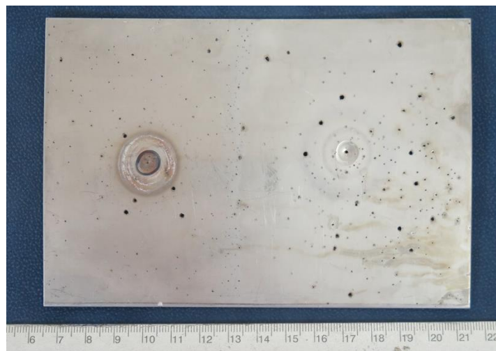
Slika 28, Uzorak čelika AISI 321 (EN 1.4541) nakon korozivnog ispitivanja. Vidljivo je osjetno oštećivanje cijele površine
