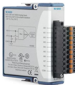
Slika 2.38. Modul NI 9203 za očitavanje jakosti struje [72]
