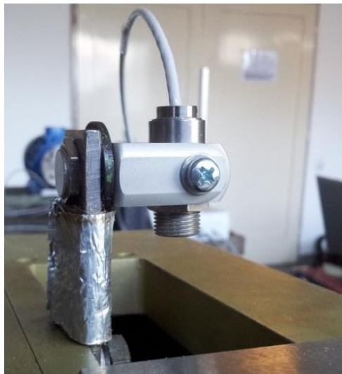
Slika 4.13 Smještaj termometra CT P7
