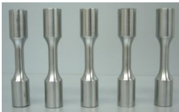
Slika 22. Polirane cilindrične epruvete za statička vlačna i ciklička ispitivanja
