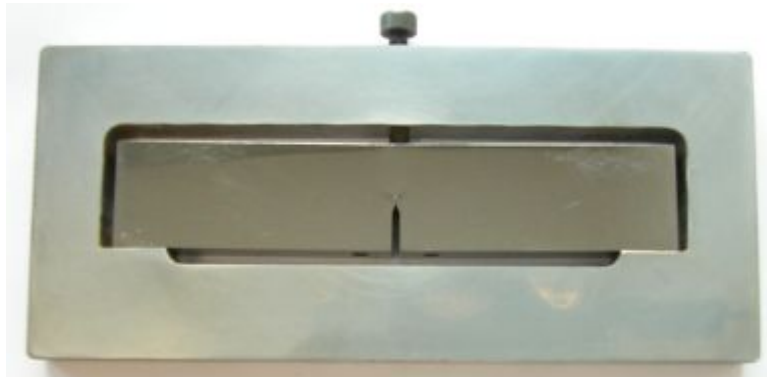
Slika 48. Naprava za opterećenje SENB epruveta
