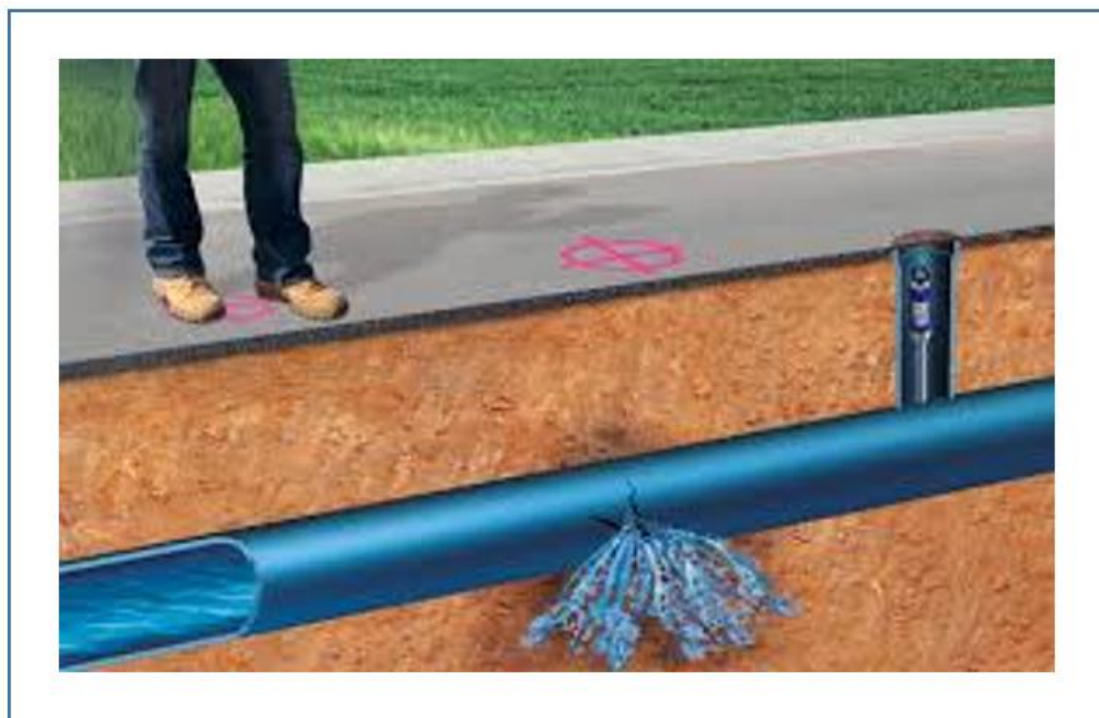
Slika 2.11: Nevidljivo istjecanje vode na detektiranom mjestu kvara [internet];
