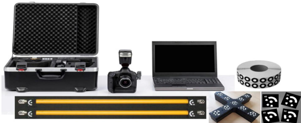
Slika 49. Cjelokupni TRITOP sustav
