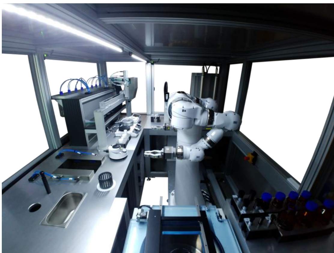
Slika 10. Potpuna automatizacija robotom Motoman CSDA10
