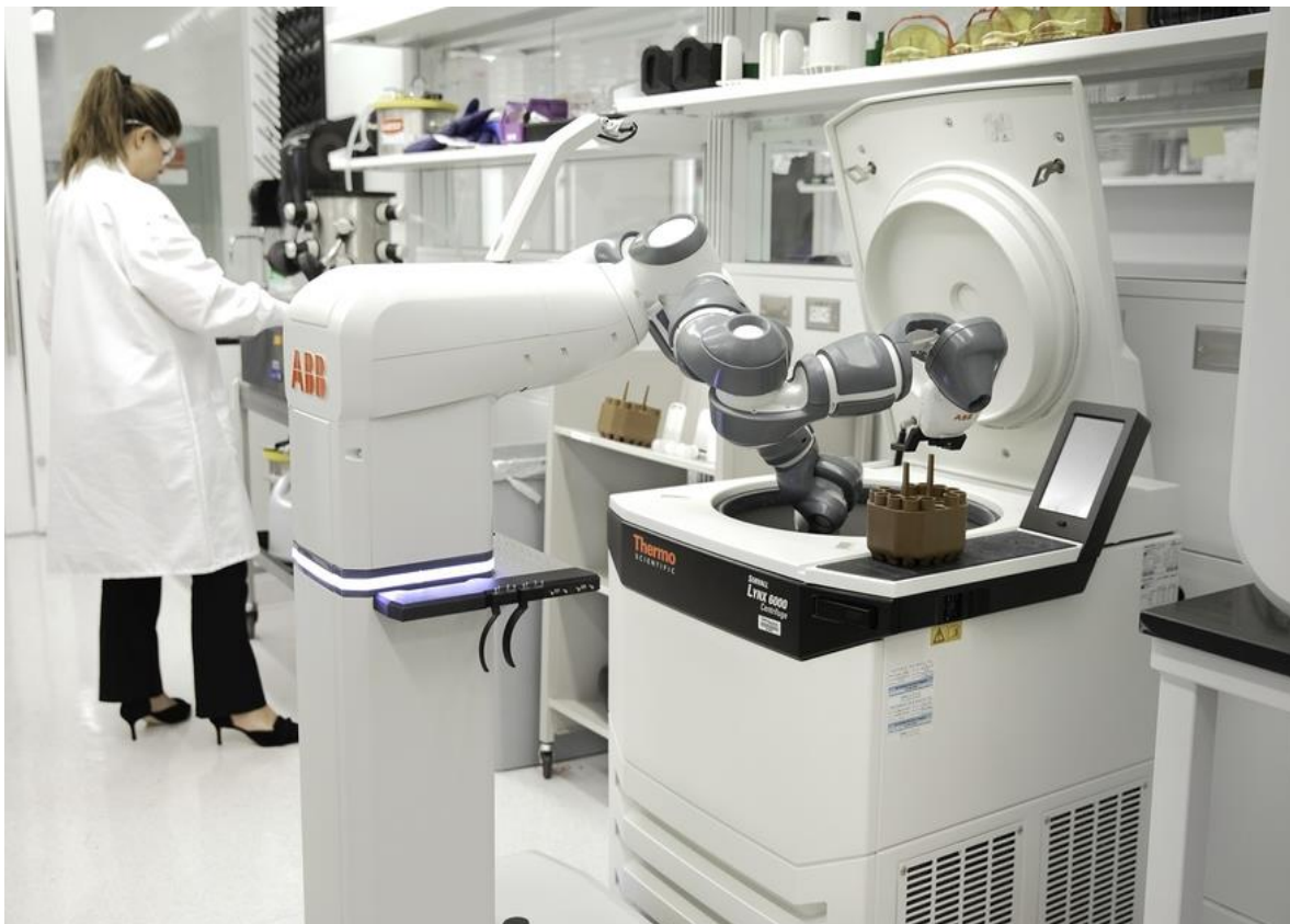
Slika 8. Robot ABB Yumi za asistenciju u laboratorijima [9]
