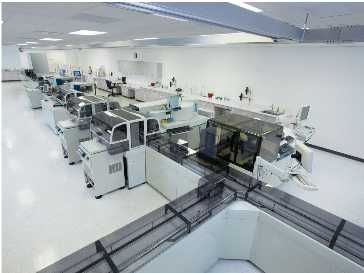
Slika 7. Potpuni sustav automatizacije laboratorija: Siemens Aptio [5]
