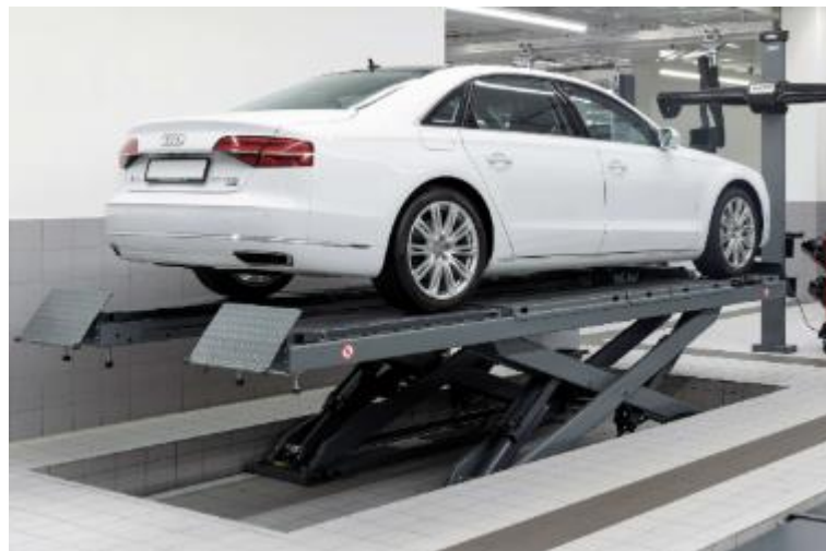
Slika 7. Ugradnja u podu [4]
