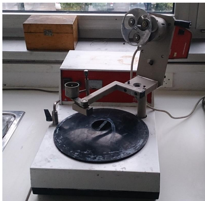
Slika 15. Uređaj za brušenje Struers Pedemin
