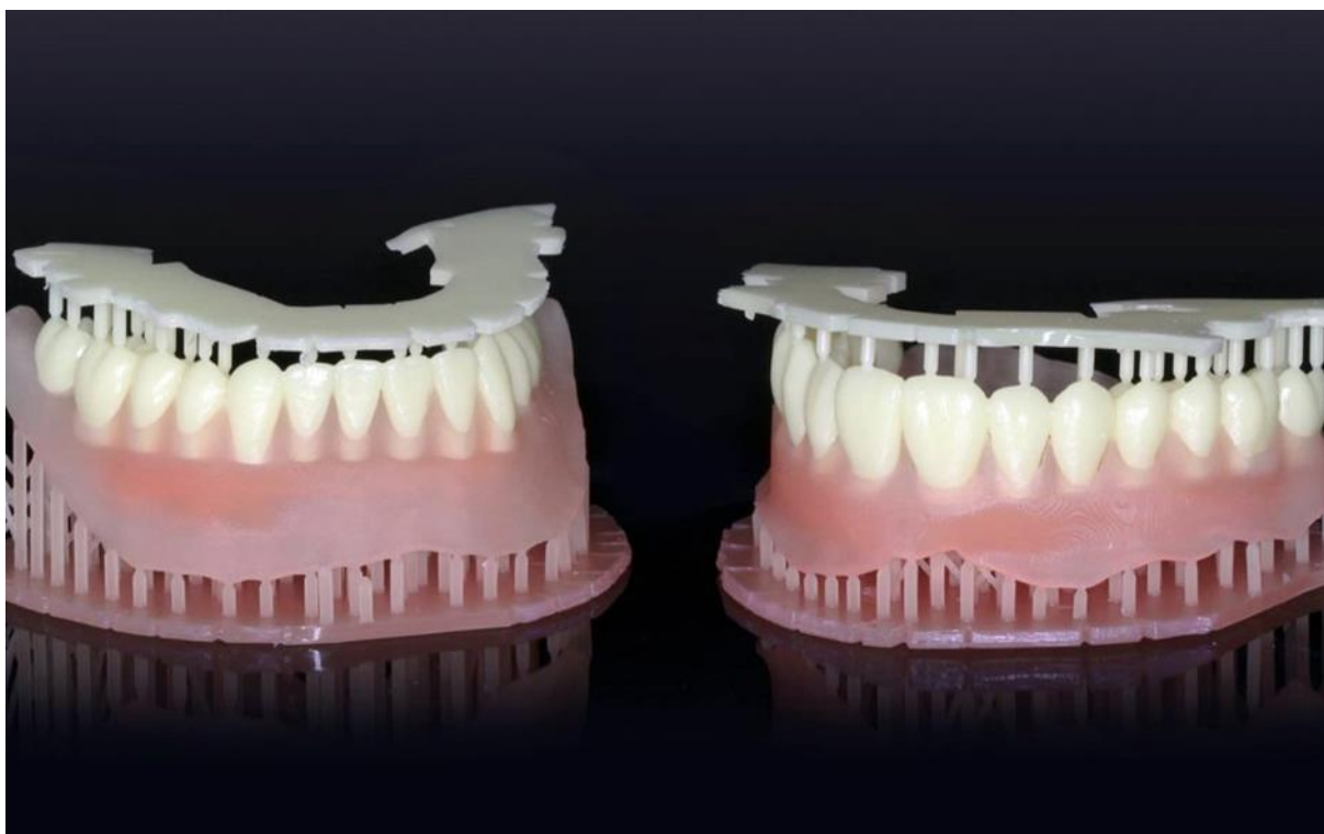
Slika 4. Dentalni implantat proizveden 3D printanjem [7]
