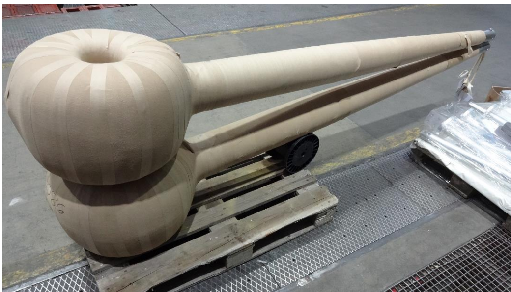
Slika 1.4. Primjer mjernih transformatora spremnih za vakuumsko sušenje
