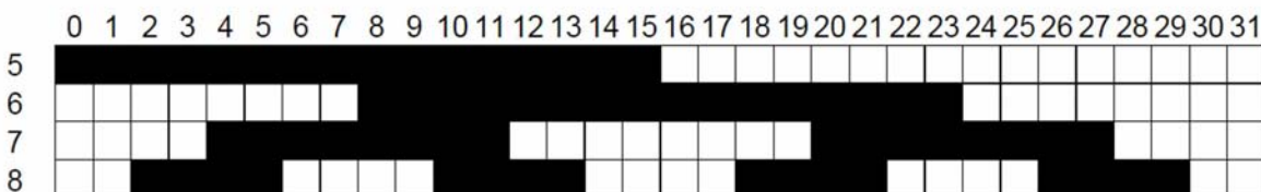
Slika 26: Princip metode Gray koda
