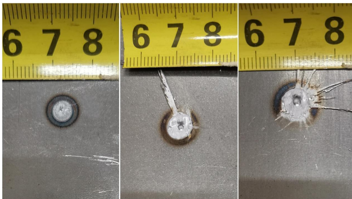
Slika 58 Uvećani prikaz mjesta loma ispitnih uzoraka 1, 2 i 3 (s lijeva na desno)
