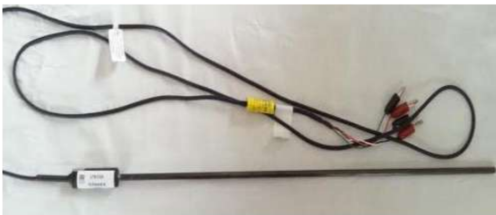
Slika 7. Platinski otpornički termometri
