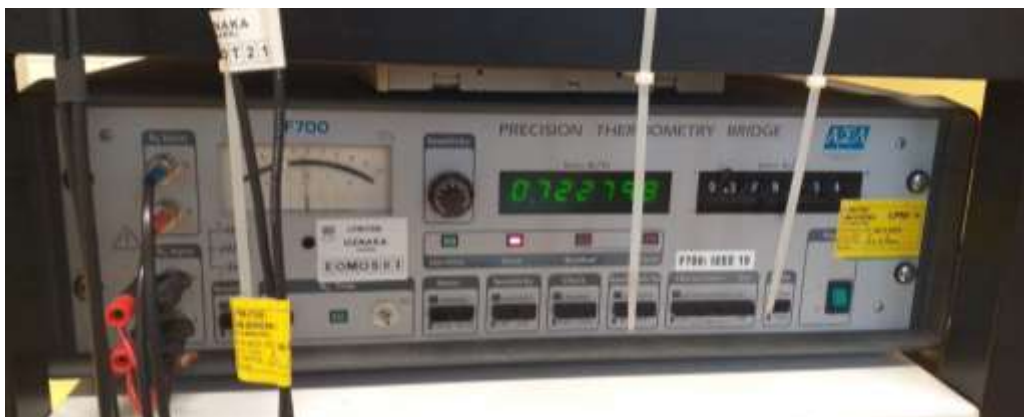
Slika 8. Termometrijski otpornički most
