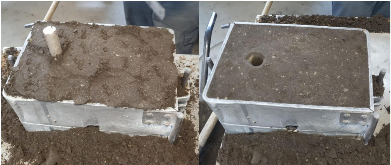
Slika 39. Sabijanje kalupne mješavine i vađenje modela pojila
