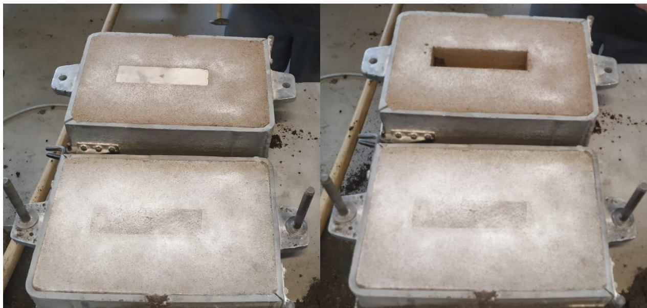
Slika 40. Otvaranje kalupa i uklanjanje modela
