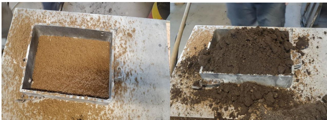
Slika 35. Dodavanje modelne i punidbene kalupne mješavine
