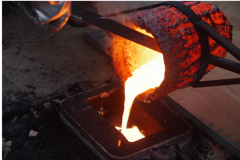
Slika 6. Primjer ulijevanja litine u jednokratni pješčani kalup [10]
