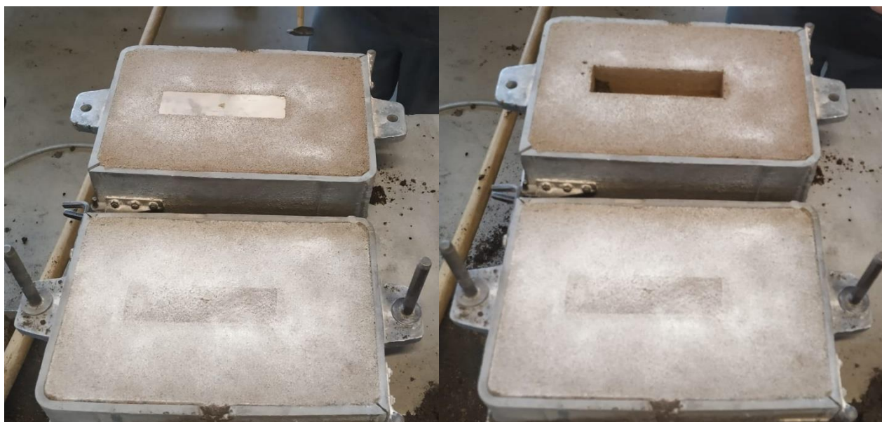
Slika 40. Otvaranje kalupa i uklanjanje modela
