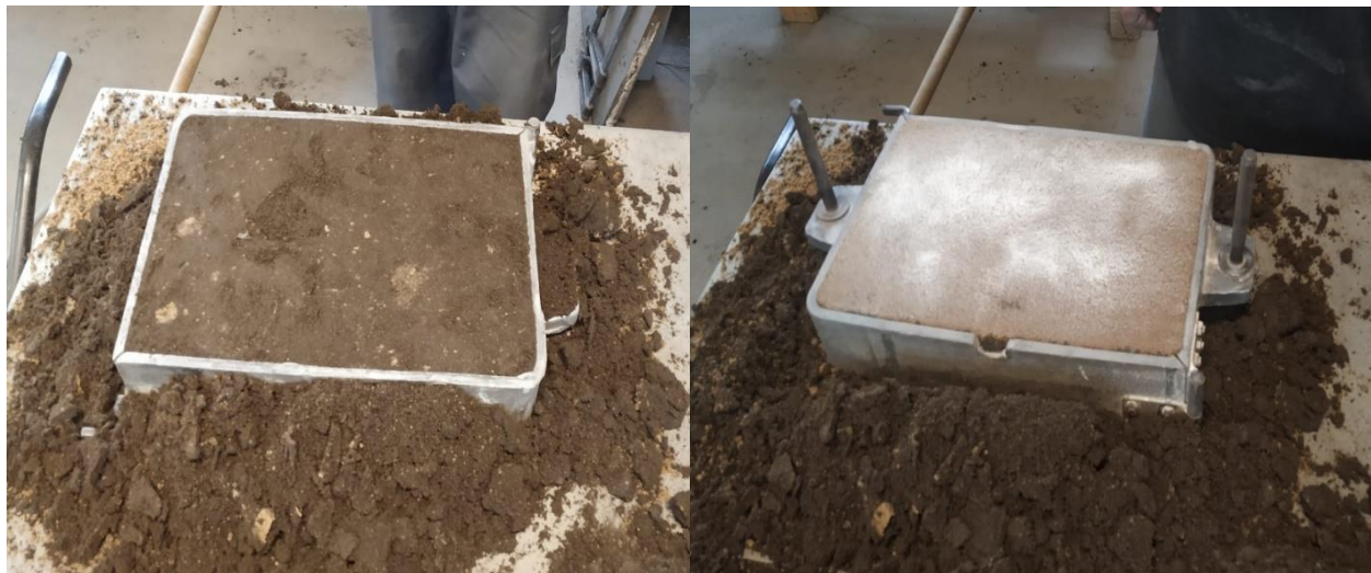
Slika 36. Sabijanje kalupne mješavine i dodavanje sredstva za razdvajanje
