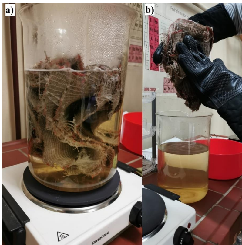
Slika 8. Prikaz procesa pranja lanenih vlakana; a) pranje u kontroliranoj kupelji, b) vađenje lanenih vlakana iz kontrolirane kupelji.
