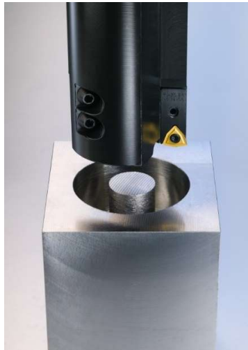
Slika 19. Alat pomoću kojeg se vrši metoda dubokih provrta [16]
