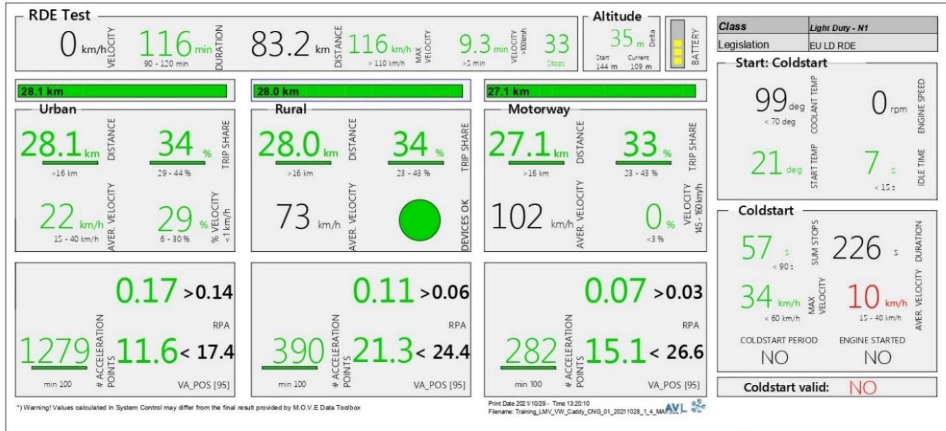
Slika 6.2.3.6.2. Prozor s parametrima Main Test-a
