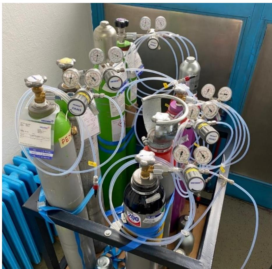
Slika 36. Plinovi korišteni za kalibraciju mjernog sustava
