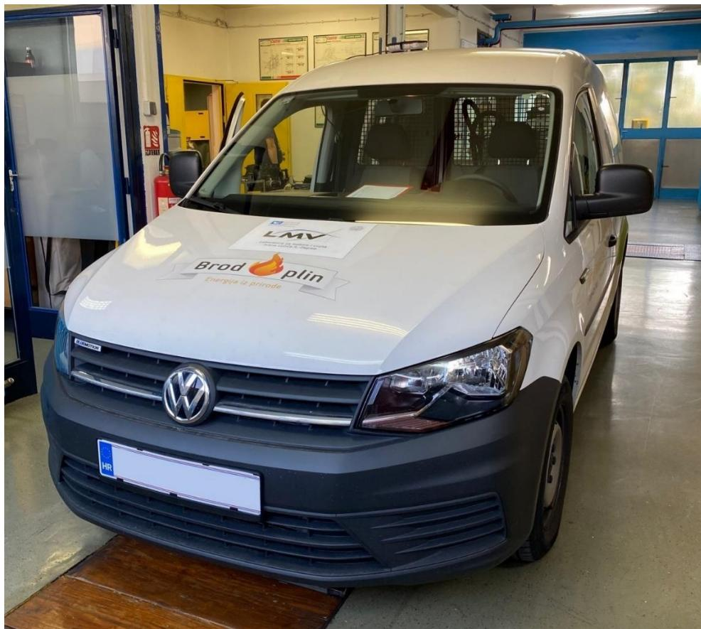
Slika 4. Ispitno vozilo VW Caddy 1.4 TGI BlueMotion
