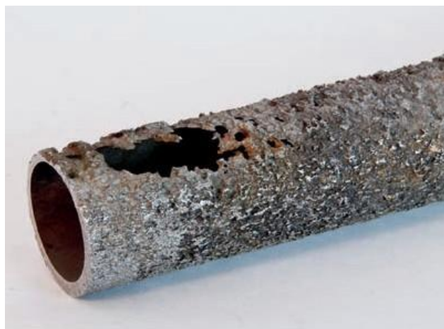
Slika 16. Opća korozija nehrđajućeg čelika uzrokovana sumpornom kiselinom [2]
