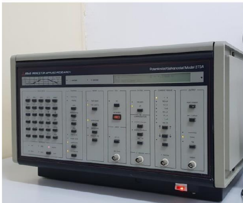
Slika 39. Potentiostat/Galvanostat Model 273A EG&E
