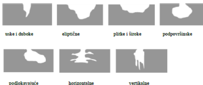
Slika 17. Oblici jama rupičaste koroziije [31]
