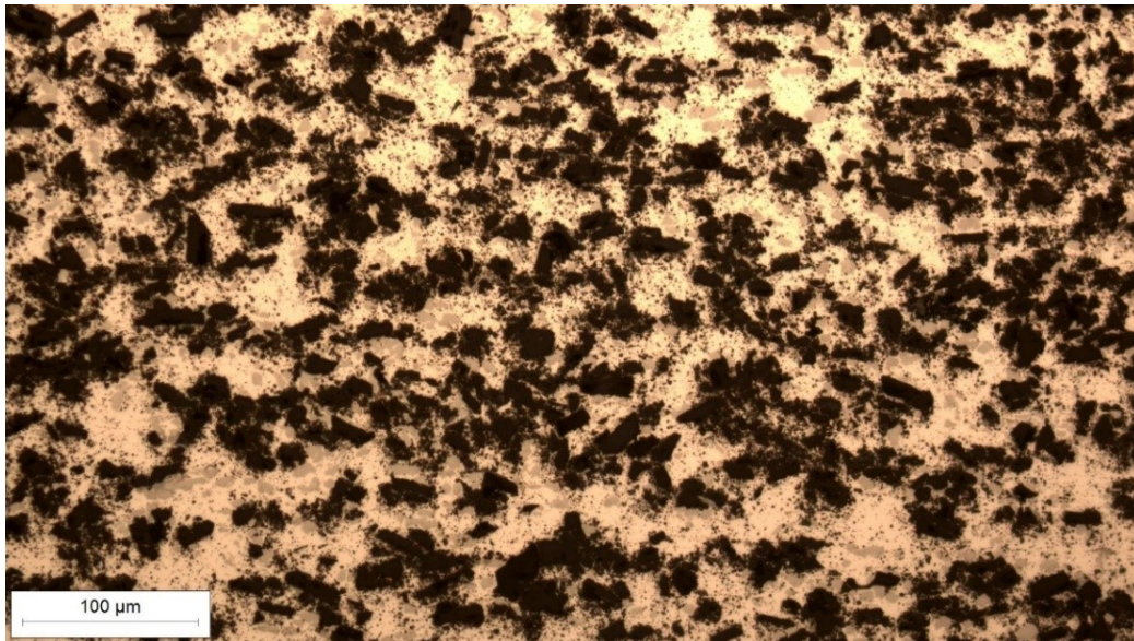
Slika 34. Mikrostruktura polirane površine uzorka 1-2 pri povećanju 200x
