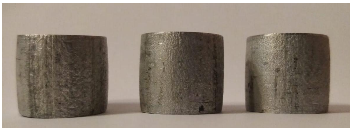
Slika 20. Uzorci nakon deformacije gdje su kontaktne površine bile glatke
