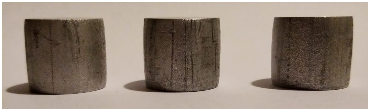
Slika 24. Uzorci nakon deformacije gdje su kontaktne površine bile glatko – hrapavo
