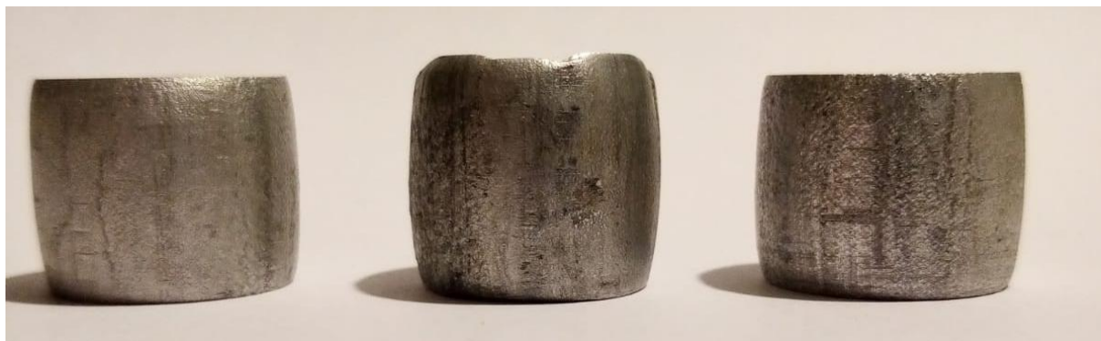
Slika 25. Uzorci nakon deformacije gdje su kontaktne površine bile hrapavo – hrapavo
