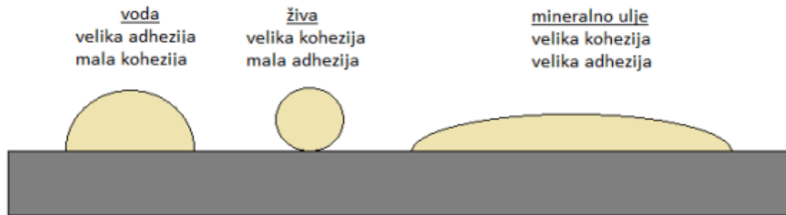
Slika 6. Djelovanje adhezije i kohezije kod vode, žive i mineralnog ulja [2]
