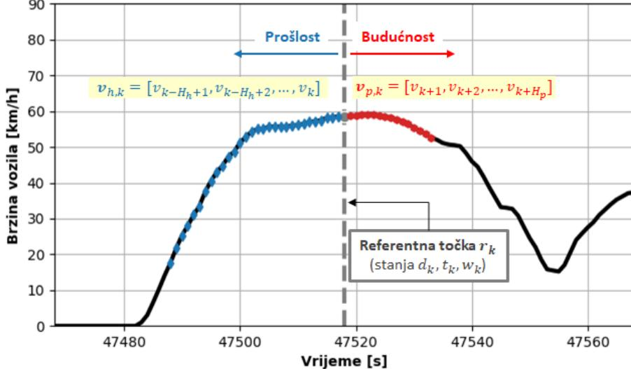
Slika 7-13: Ilustrativni prikaz postupka generiranja ulazno-izlaznih podataka (tj. skupova  $\mathcal{X}$  i  $\mathcal{Y}$ ) za učenje, validaciju i testiranje NN-DET modela.
