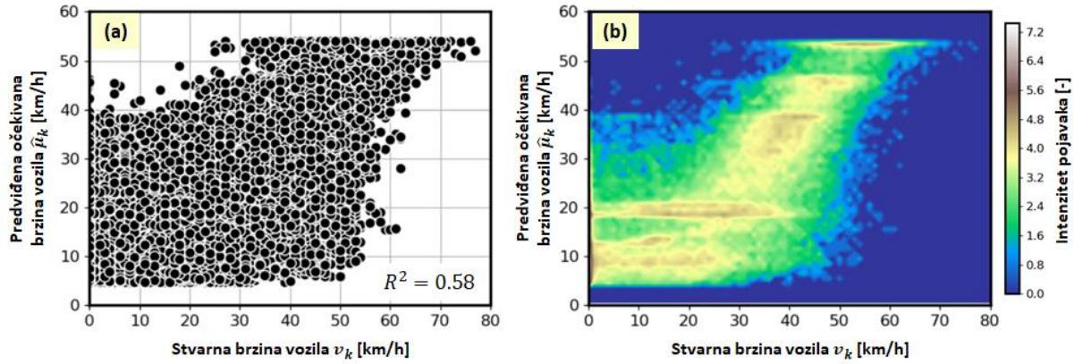
Slika 7-7: a) *Predviđene srednje vrijednosti brzine vozila  $\mu_k$  dobivene primjenom NN-STC modela na temelju testnog skupa podataka u odnosu na snimljene vrijednosti brzine vozila  $v_k$ , te b) pripadna toplinska mapa.*
