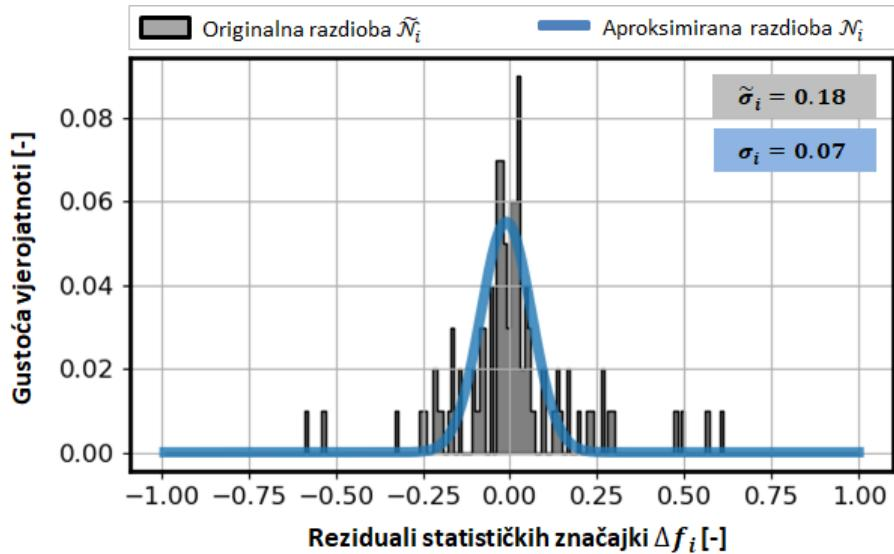
Slika 5-3: Primjer aproksimacijske krivulje definirane normalnom razdiobom  $\mathcal{N}_i$  čiji se parametri  $\mu_i$ ,  $\sigma_i$  uče na originalnoj razdiobi reziduala statističkih značajki  $\tilde{\mathcal{N}}_i$ .
