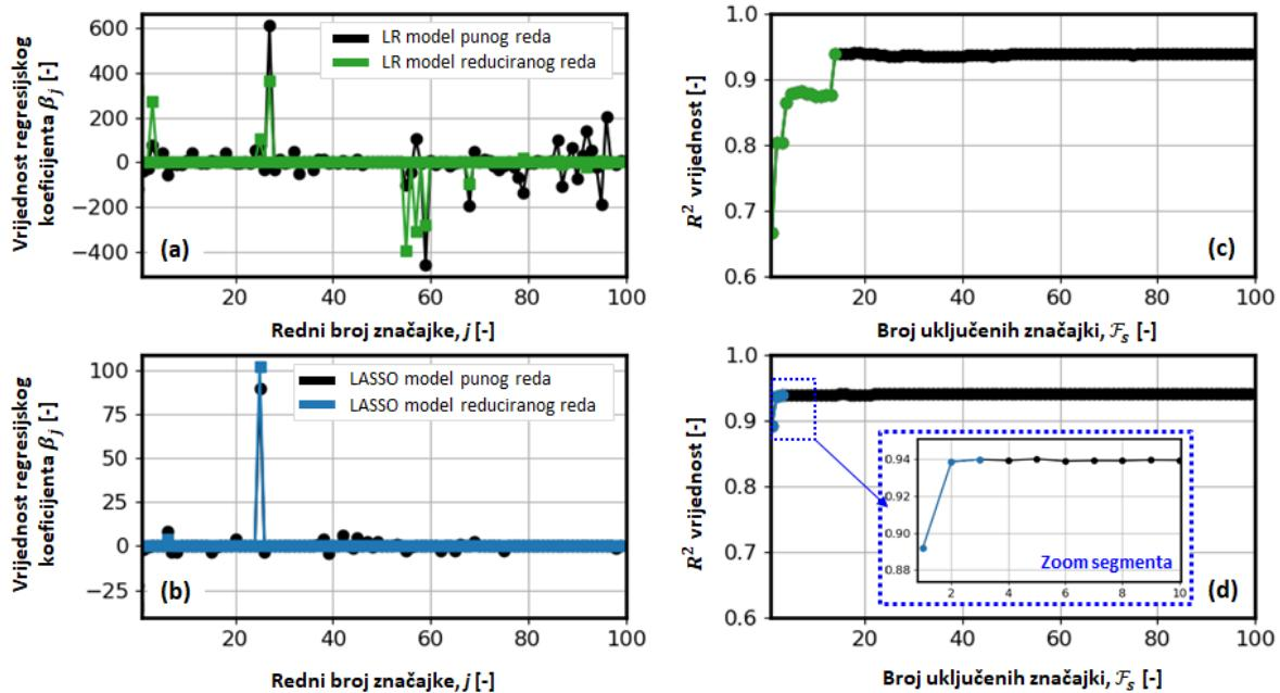
Slika 6-4: Vrijednosti koeficijenata regresije  $\hat{\beta}_j$  za slučaj a) LR i b) LASSO modela punog i reduciranih reda; te postignute  $R^2$  vrijednosti c)LR i d) LASSO modela u ovisnosti o broju ulaznih značajki tj. parametara.
