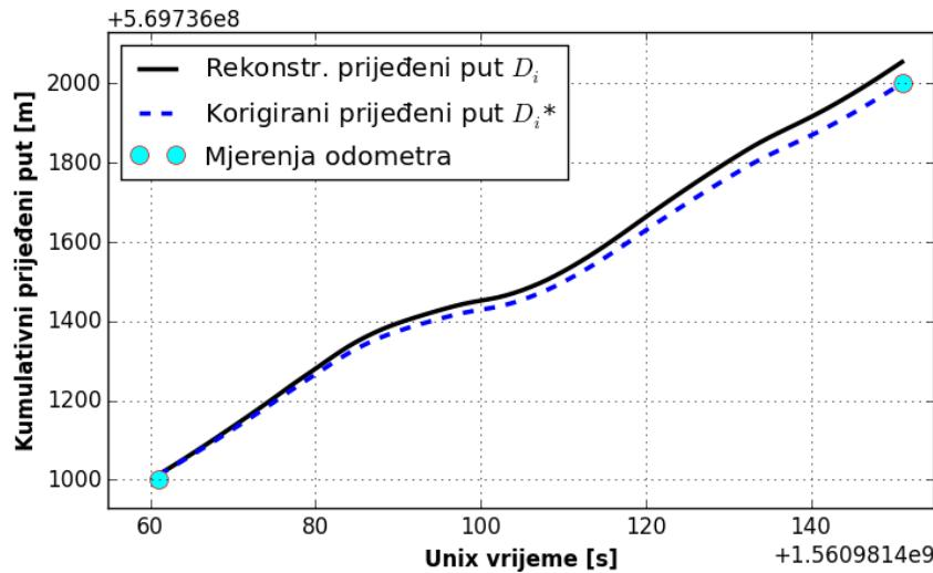
Slika 2-2: Primjer GPS-rekonstruiranog  $D_i$  i temeljem odometra-korigiranog  $D_i^*$  profila prijeđenog puta između dva susjedna mjerena odometra.
