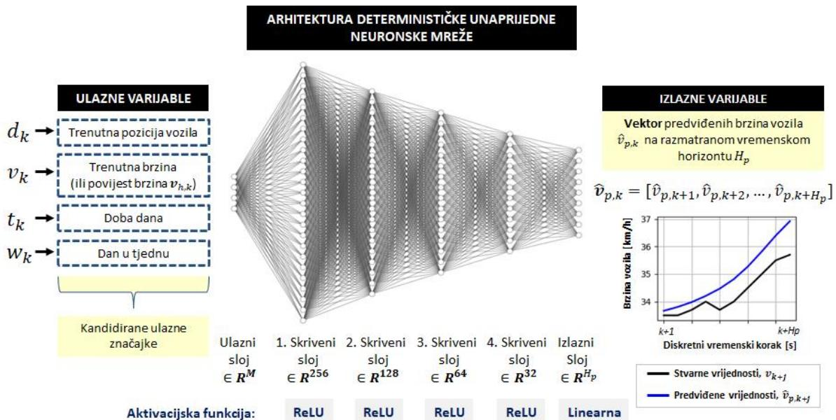
Slika 7-12: Predložena arhitektura determinističke unaprijedne višeslojne neuronske mreže (NN-DET) za predviđanje profila brzine vozila na horizontu u budućnosti  $\hat{v}_{p,k}$  na temelju trenutne pozicije vozila  $d_k$ , trenutne brzine  $v_k$  (ili povijesti brzina  $v_{h,k}$ ), doba dana  $t_k$  i dana u tjednu  $w_k$ .
