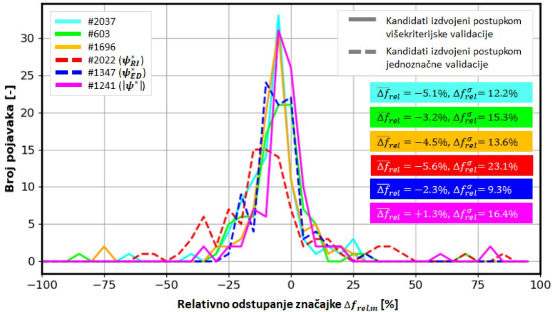
Slika 6-9: Razdiobe relativnih odstupanja statističkih značajki ( $\Delta f_{rel,m}$ ) za svih šest reprezentativnih sintetičkih voznih ciklusa izdvojenih temeljem postupka jednoznačne ili višekriterijske validacije, zajedno s pripadnim prosječnim vrijednostima ( $\bar{\Delta f}_{rel}$ ) i standardnim devijacijama ( $\Delta f_{rel}^\sigma$ ), izračunate za cjelokupan skup nominiranih statističkih značajki  $\mathcal{F}$ .
