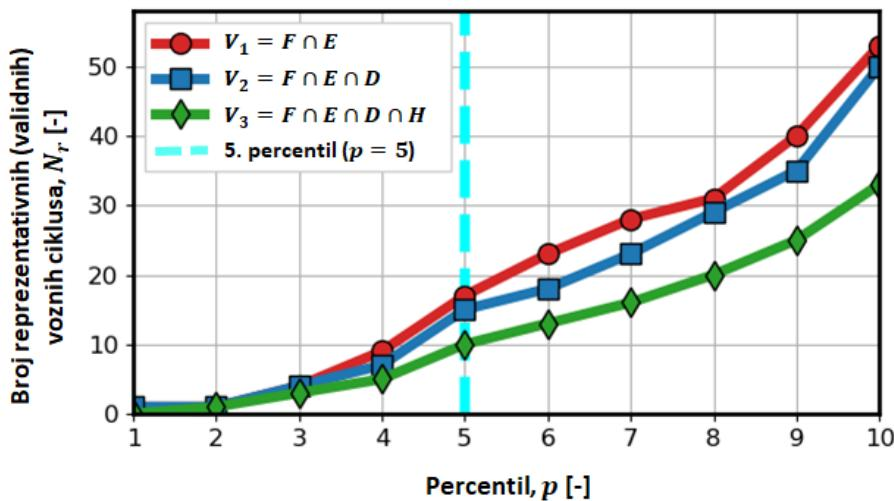
Slika 5-7: Ovisnost broja validnih sintetičkih voznih ciklusa  $N_r$  u podskupovima  $V_1$ ,  $V_2$  te  $V_3$  o graničnim vrijednostima pokazatelja reprezentativnosti definiranim  $p$ -tim percentilom.
