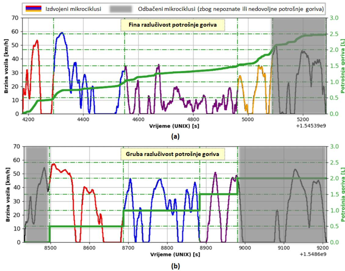
Slika 4-2: Ilustracija postupka razdvajanja snimljenog voznog ciklusa na skup mikrociklusa ekvivalentne potrošnje goriva od 0.5 L za slučaj a) fine i b) grube razlučivosti snimljene potrošnje goriva.
