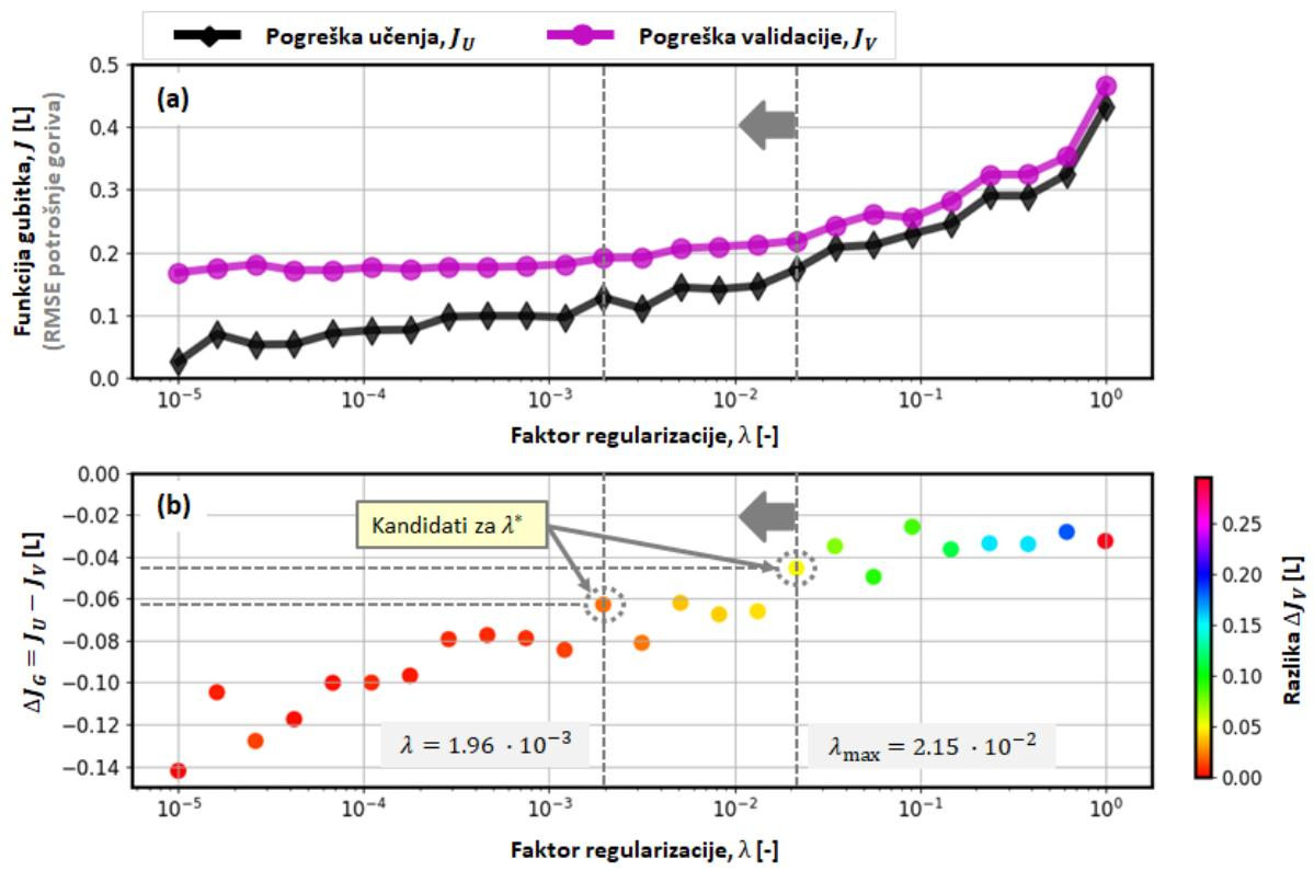
Slika 4-21: Rezultati regularizacije NN-H3D modela: a) krivulje pogreške učenja i validacije i b) razlika pogreške učenja i validacije u ovisnosti o vrijednosti faktora regularizacije  $\lambda$ . Obojana skala ( $\Delta J_V$ ) označava porast validacijske pogreške u odnosu na vrijednost dobivenu bez regularizacije.
