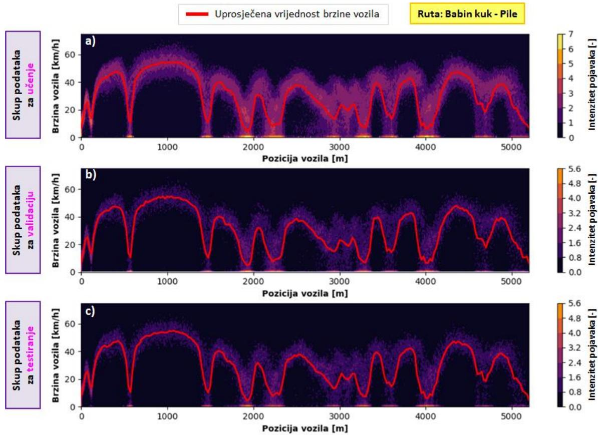
*Slika 7-5: Toplinske mape rasipanja snimljenih brzina vozila  $v_k$  duž rute u domeni pozicije vozila, sadržanih u skupu podataka za a) učenje, b) validaciju i c) testiranje NN-STC modela, uključujući po poziciji uprosječene vrijednosti brzine vozila (crvena linija).*
