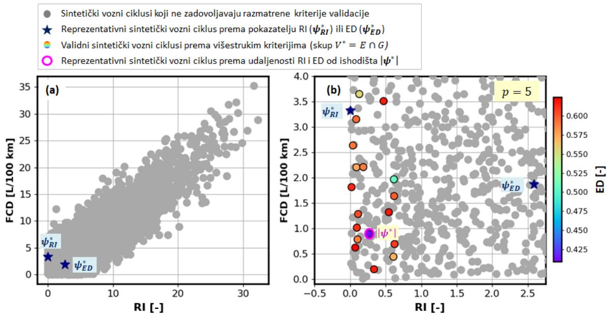
*Slika 6-6: Pozicije reprezentativnih sintetičkih voznih ciklusa dobivenih temeljem a) jednoznačne validacije prema kriteriju minimalne vrijednosti pokazatelja RI i ED ( $\psi_{RI}^*$ ,  $\psi_{ED}^*$ ) te b) minimalne udaljenosti od ishodišta RI – ED koordinatnog sustava ( $|\psi^*|$ ).*
