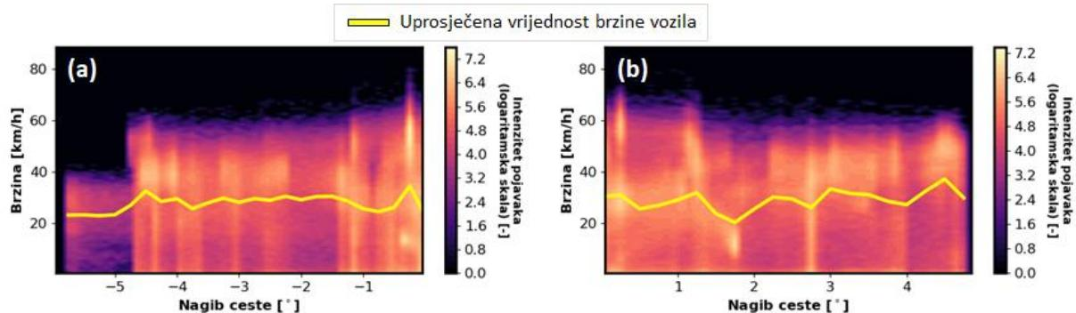
Slika 2-14: Toplinske mape brzine vozila s obzirom na a) negativne i b) pozitivne vrijednosti nagiba ceste za objedinjenu rutu BK-P-BK, uključujući po nagibu uprosječene vrijednosti brzine vozila.
