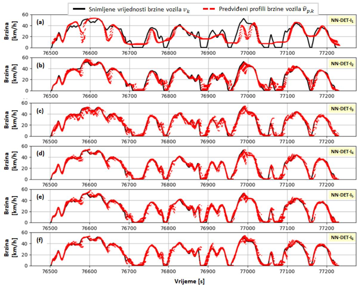
Slika 7-15: Predviđeni profili brzine vozila (crvena isprekidana linija) u odnosu na snimljene vrijednosti (crna puna linija), prikazani na primjeru jednog testnog voznog ciklusa i za svaki  $NN-DET-I_n$  model zasebno.
