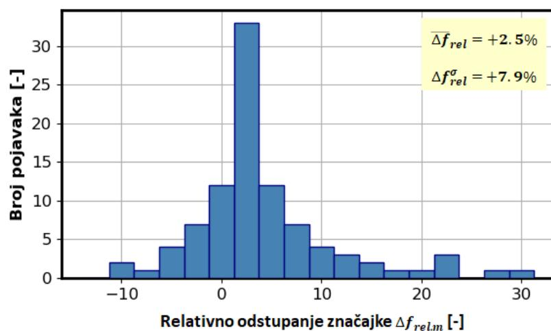
Slika 5-2: Histogram relativnih odstupanja očekivanih vrijednosti svih 100 razmatranih statističkih značajki ( $\Delta f_{rel,m}$ ) za kombinirani sintetički u odnosu na snimljeni vozni ciklus, zajedno s pripadnom prosječnom vrijednosti ( $\overline{\Delta f}_{rel}$ ) i standardne devijacije ( $\Delta f_{rel}^\sigma$ ).
