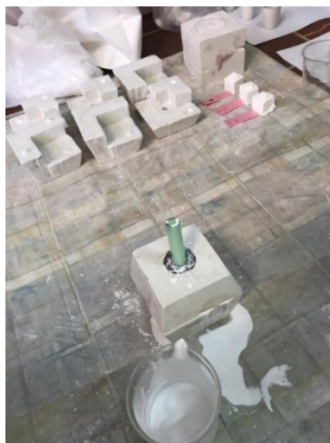
Slika 7.2 Prikaz korištenih kalupa za provedbu oblikovanja keramike lijevanjem suspenzije.
