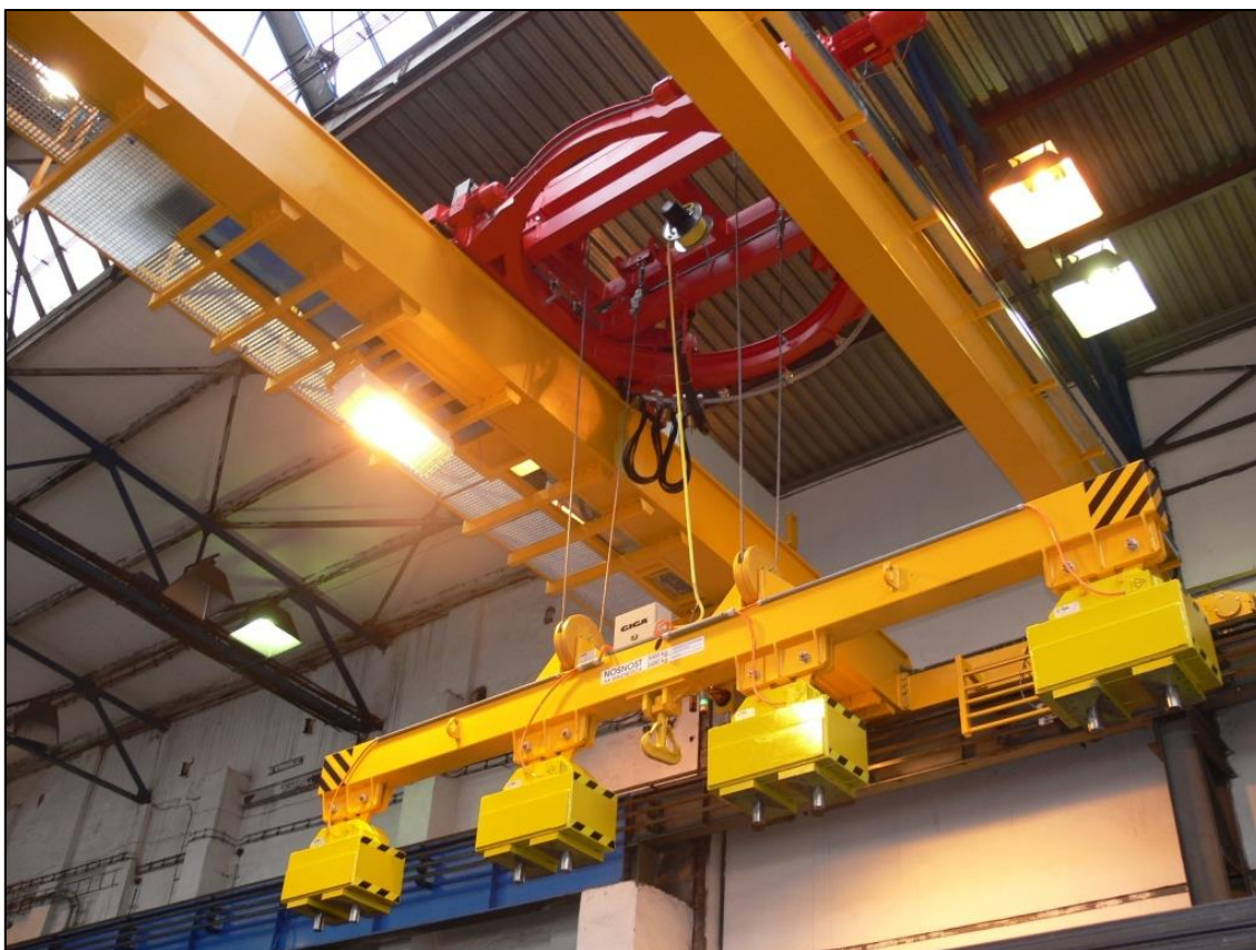
Slika 7. Mosni granik s vozičom vitla i rotacijom tereta tvrtke Giga [8]
