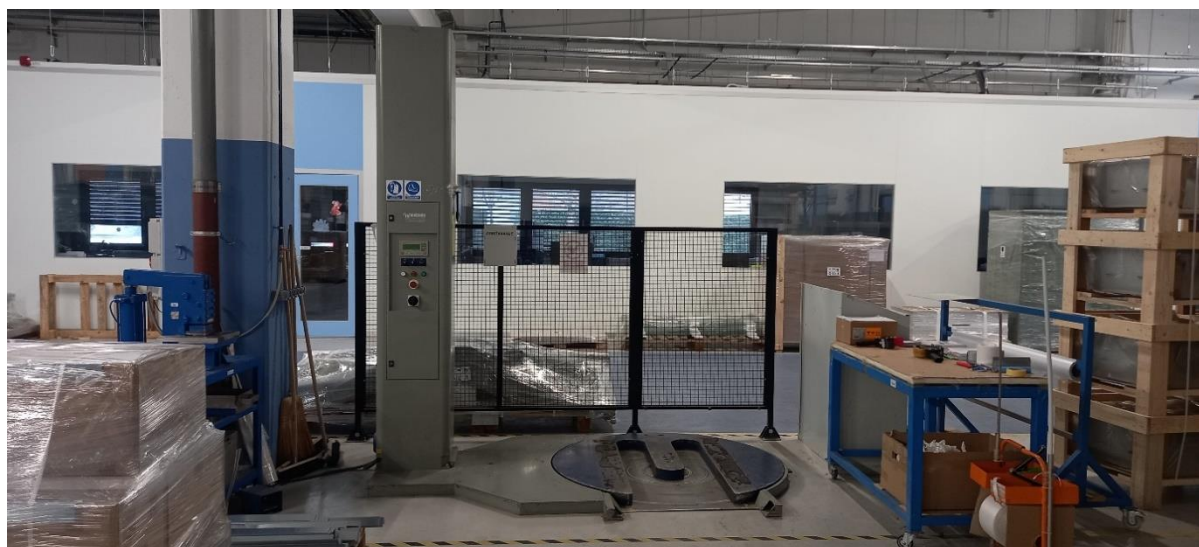
Slika 15. Stroj za omatanje paleta
