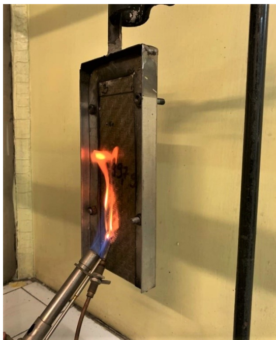
Slika 32. Gorenje ispitnog tijela izlaganjem površine plamenu
