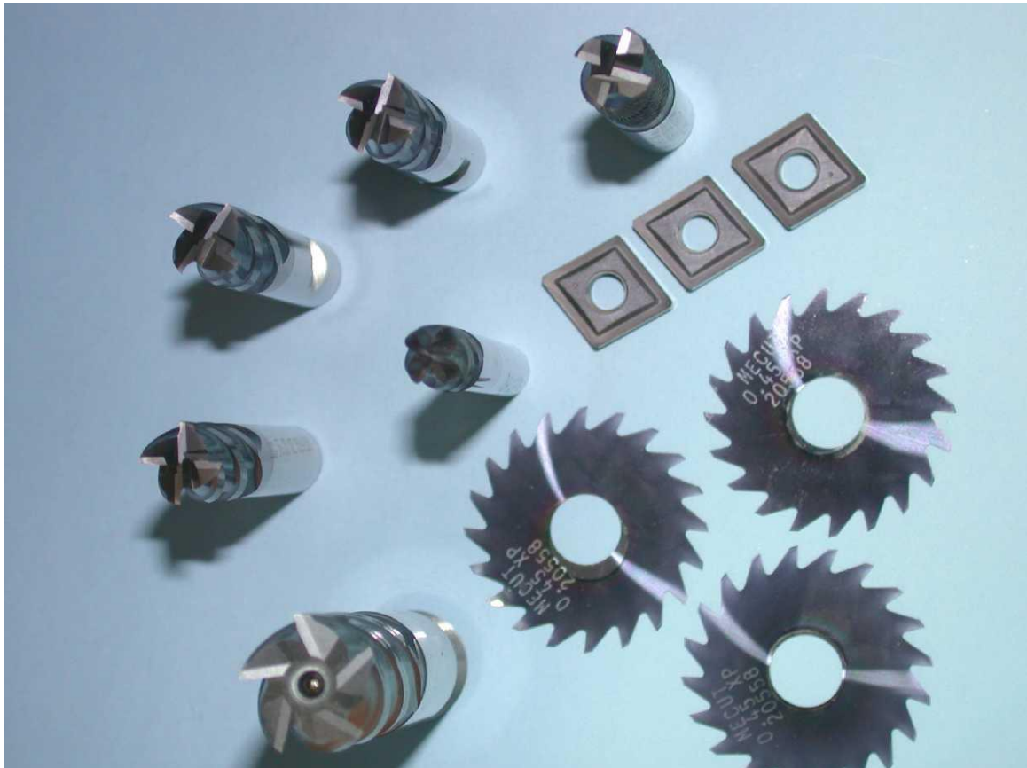
Slika 63: Prikaz reznih alata prevučeni (Ti,Al)N prevlakom [27]
