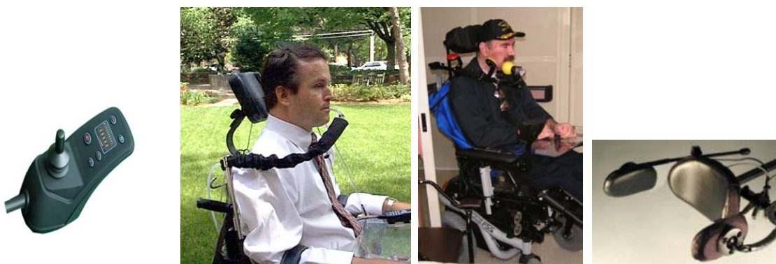
Slika 4 Razni sustavi upravljanja motoriziranih kolica (s lijeva na desno): upravljanje palicom, upravljanje dahom, upravljanje bradom, upravljanje glavom
