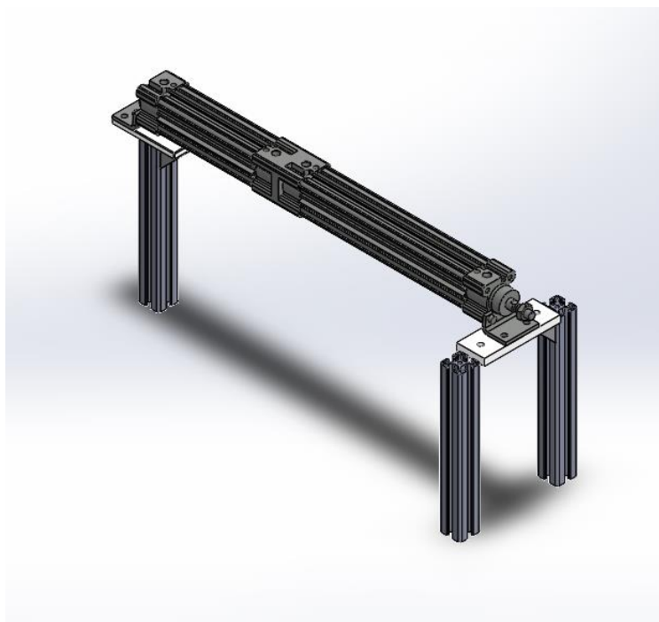
Slika 3.18 Spoj pneumatskog cilindra i potporne konstrukcije
