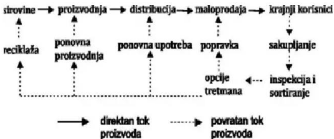
Slika 8. Pojednostavljena shema aktivnosti povratne logistike [19]
