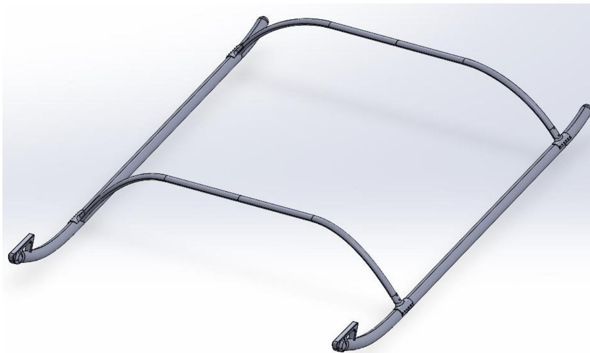
Slika 31. CAD model podvozja helikoptera
