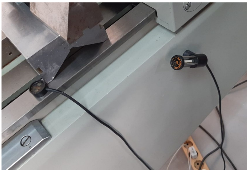
Slika 4.3 Senzori temperature zraka i materijala postavljeni na mjerni uređaj
