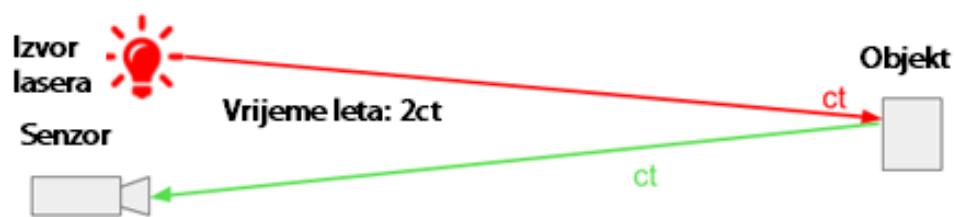
Slika 3. Princip rada TOF metode [5]
