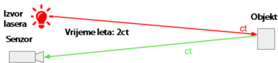
Slika 3. Princip rada TOF metode [5]
