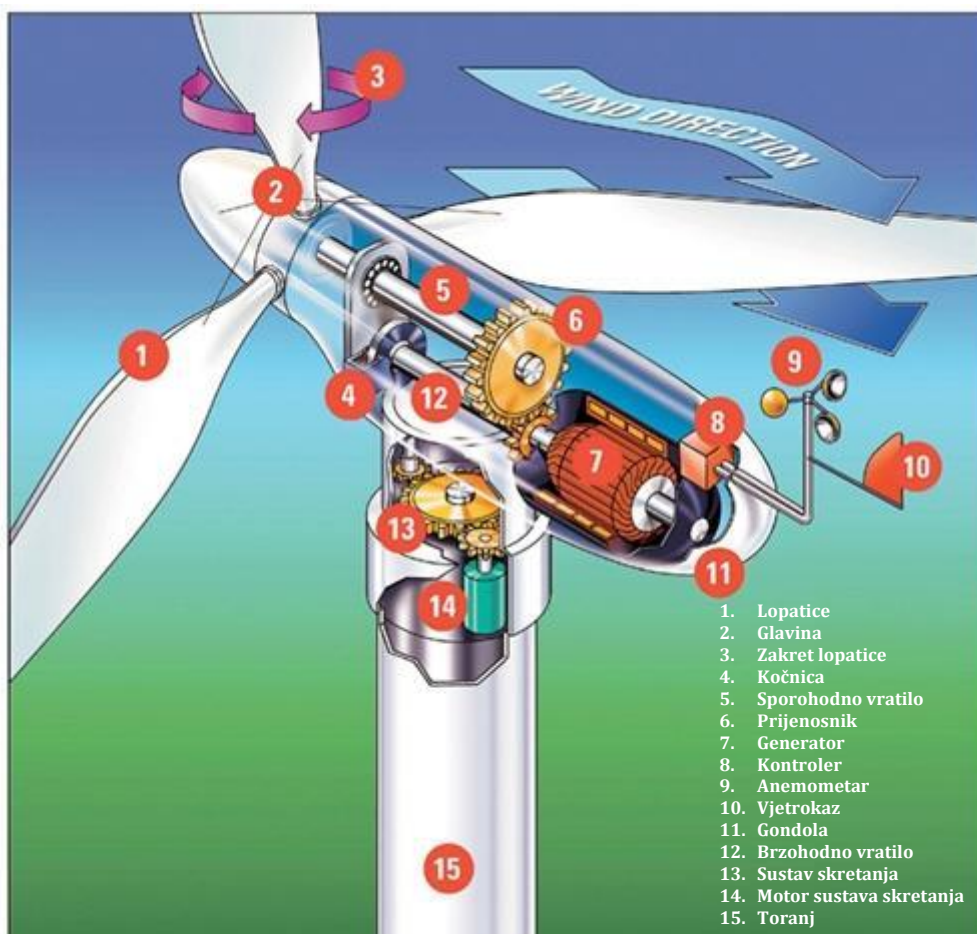
Slika 3.1 Shematski prikaz dijelova vjetroturbina
