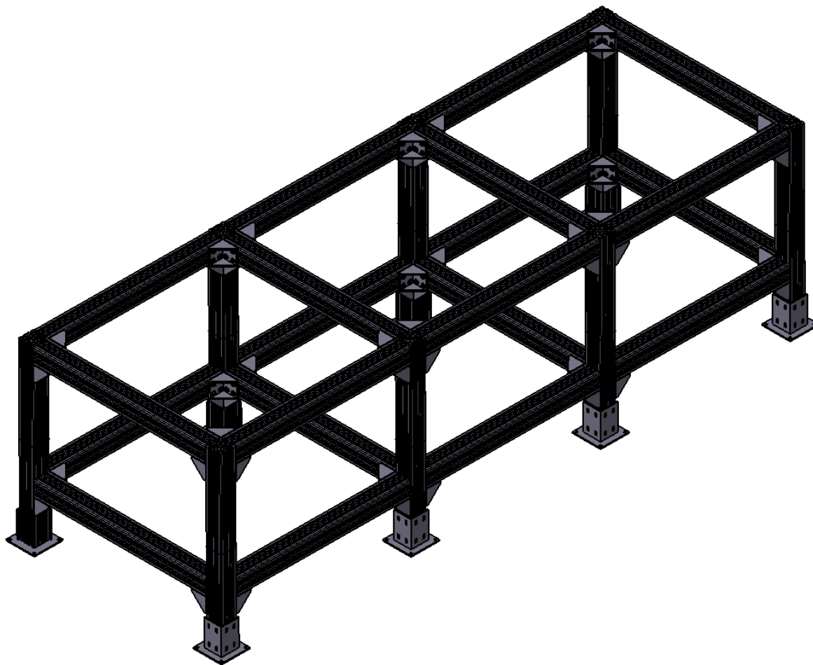
Slika 33. Postolje transportnog sustava za kotače
