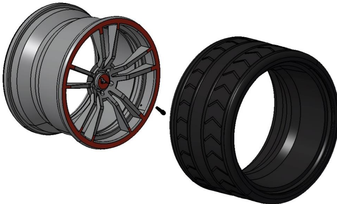
Slika 14. Eksplozirani prikaz sklopa naplatak-guma
