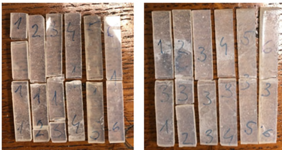
Slika 34. Ispitni uzorci s metalnim nanočesticama SiO 2 – 1 wt% (lijevo) i 2 wt% (desno) nakon provedenog savojnog ispitivanja
