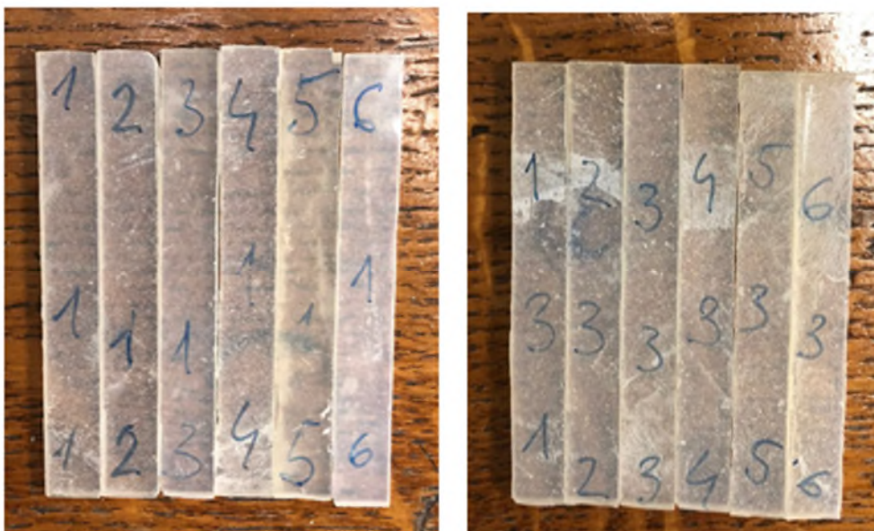
Slika 31. Izrezani ispitni uzorci s metalnim nanočesticama \text{SiO}_2 – 1 wt% (lijevo) i 2 wt% (desno)
