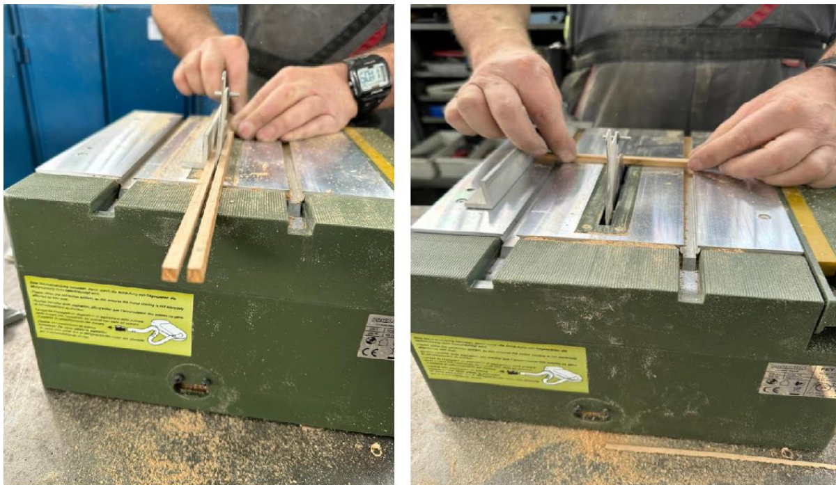
Slika 32. Rezanje uzoraka za savojno ispitivanje
