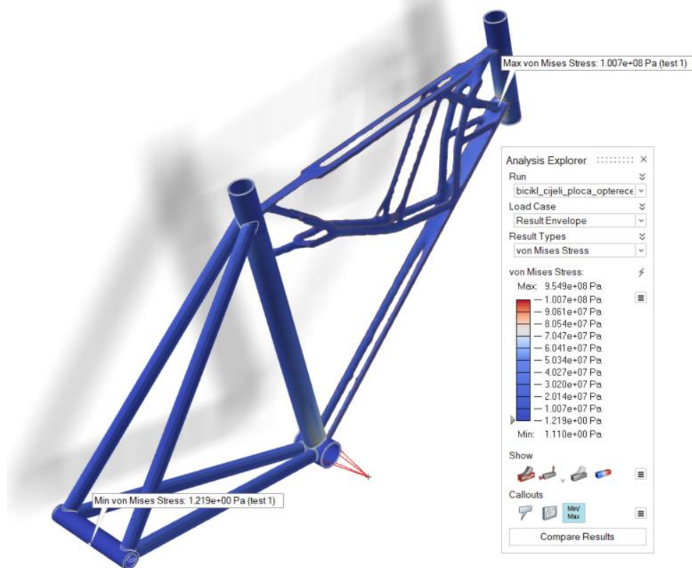
Slika 57. Rezultati testiranja optimiranog okvira, naprezanje
