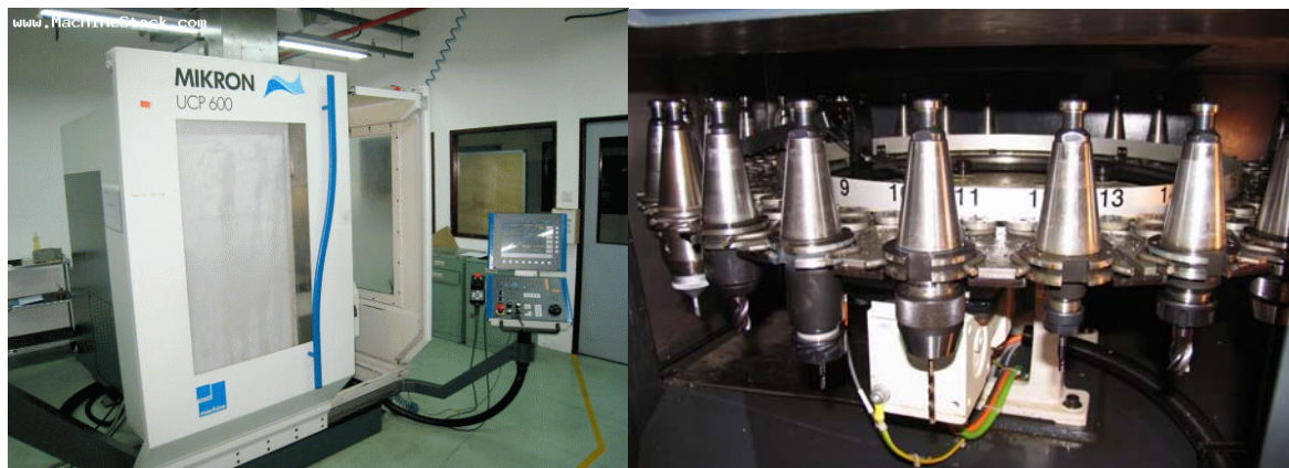
Slika 6 Obradni centar MIKRON UCP 600 VARIO sa 32 alata
