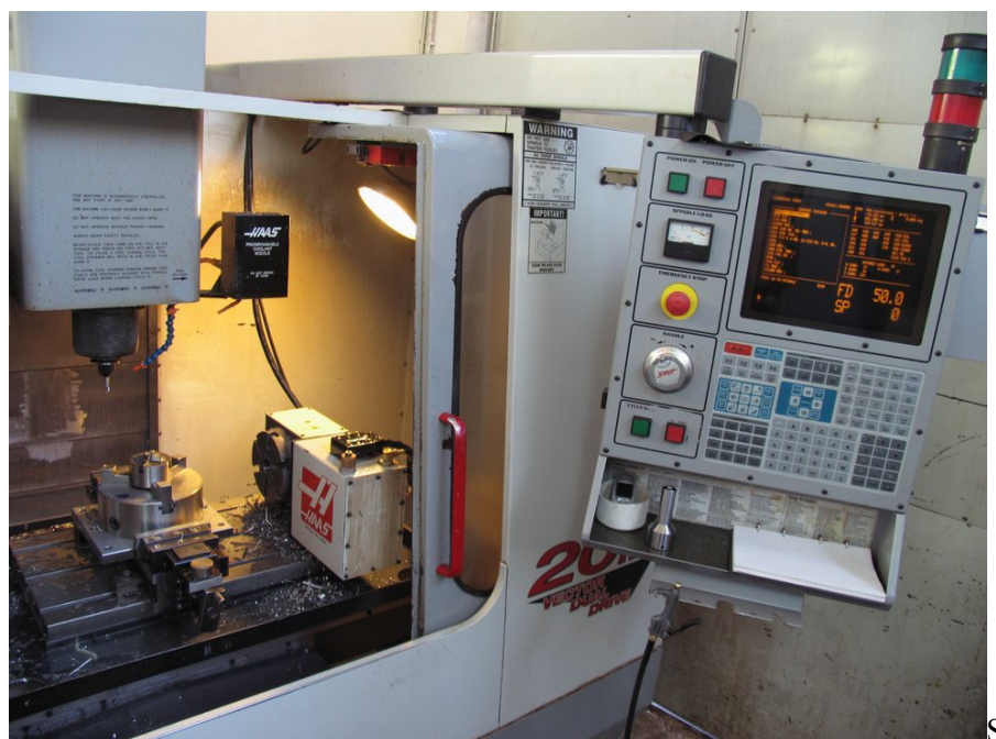
Slika 7. HAAS VF0 4-osni OBRADNI CENTAR
