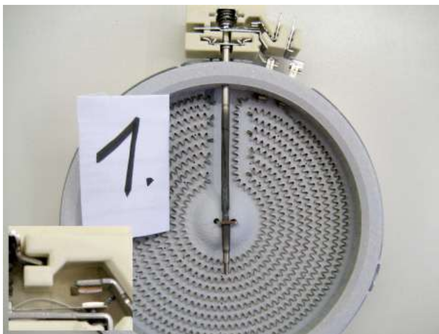
Slika 3. Primjena štapnog limitera u grijaćoj ploči
