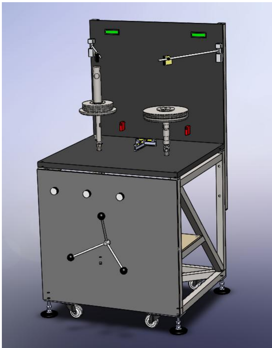
Slika 20. Idejno rješenje laboratorijskog stola
