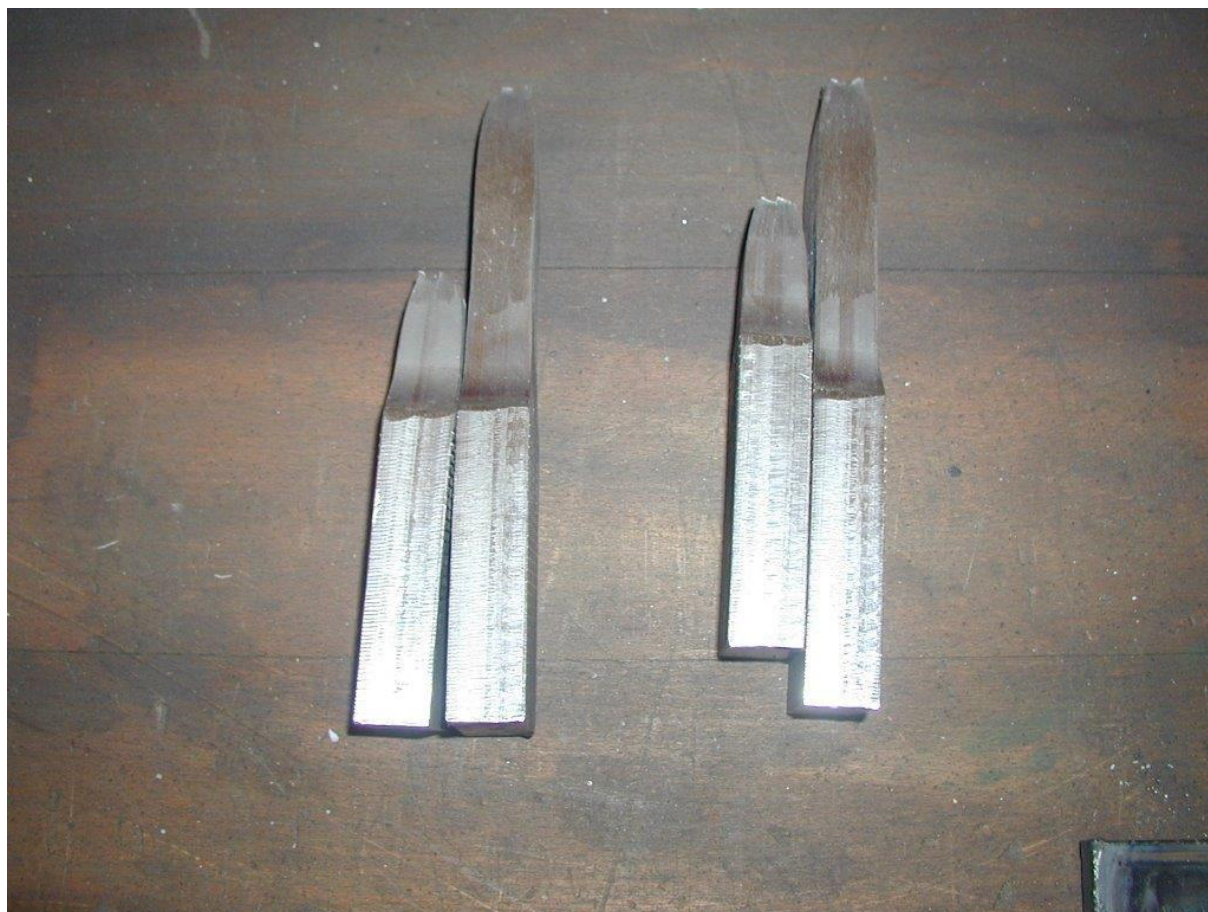
Slika 20. Epruvete nakon provedbe statičkog vlačnog ispitivanja [19]
