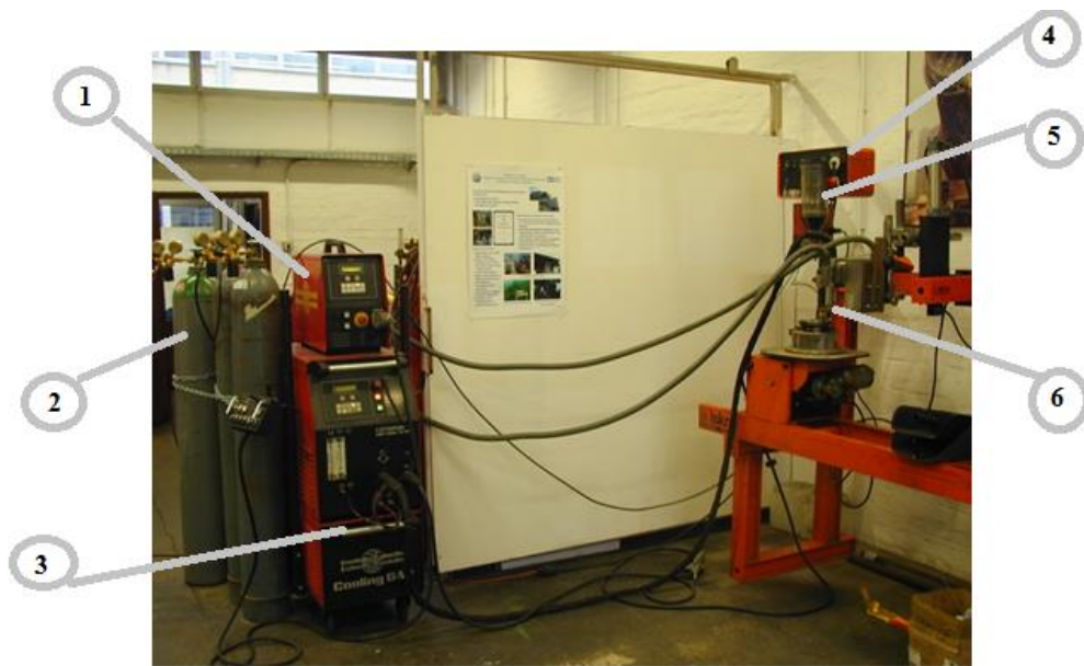
Slika 22 Oprema za plazma navarivanje praškom [18]
