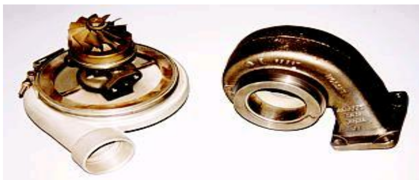
Slika 5 Primjena toplinskog naštrecavanja u automobilskoj industriji [9]
