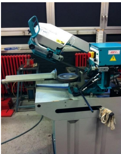
Slika 25 Tračna pila pomoću koje su izrezani uzorci
