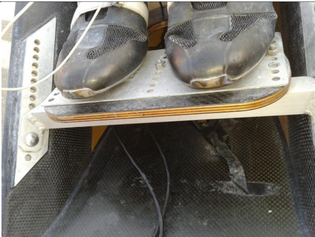
Slika 25. Prikaz spoja nogara preko aluminijskog lima na ploču od šperpoloče ojačane ugljičnim vlaknima impregniranim epoksidnom smolom
