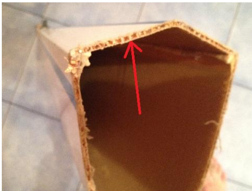
Slika 7. Presjek pramca od aramidne sendvič-konstrukcije
