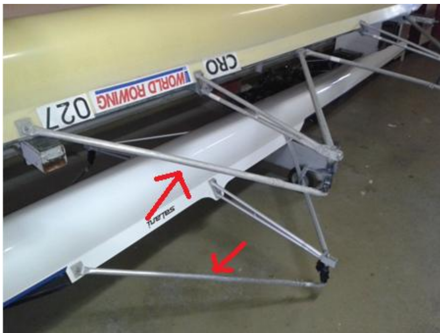
Slika 12. Izbočnici s „petom šipkom“
