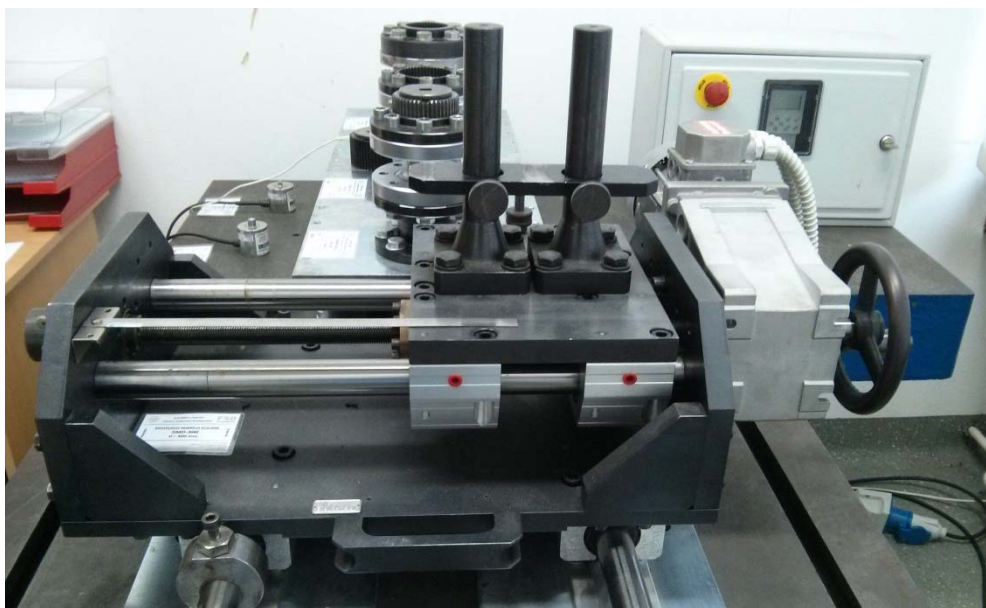
Slika 11. Mehanizam za opterećivanje uređaja
