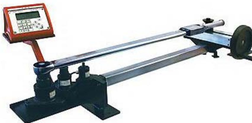
Slika 9. Postolje TWL 1500 s odgovarajućim mjernim pretvornikom [3]
