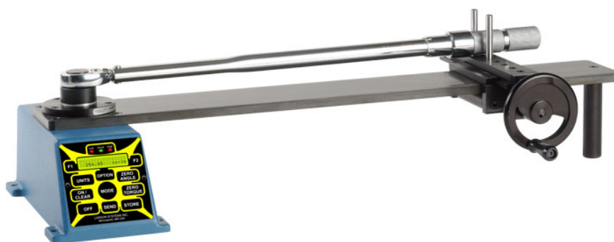
Slika 10. STWCS mjerna jedinica s priključkom za opterećivanje [6]
