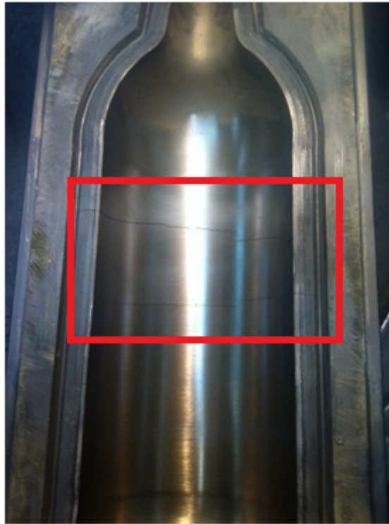
Slika 97. Pukotine kod brončanog kalupa - primjer 2
