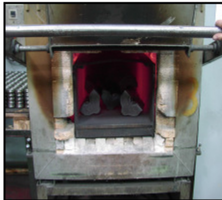
Slika 11. Zagrijavanje polovica kalupa u specijalnoj peći[2]
