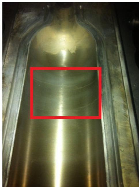
Slika 96. Istrošenost brončanog kalupa- primjer 1
