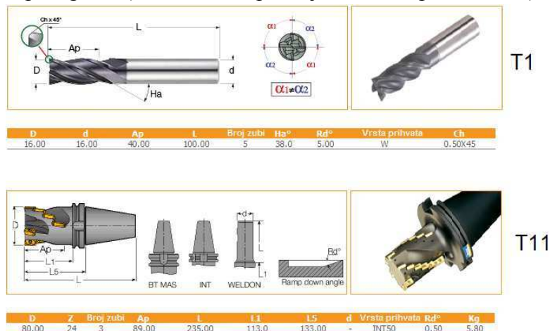
Slika 50. Dimenzije glodala T1 i T11
